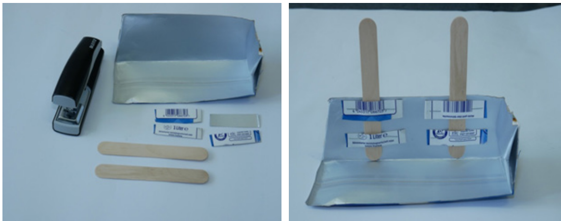
Abb. 6: Streckenverbindung mit aufgeklebten Laschen
