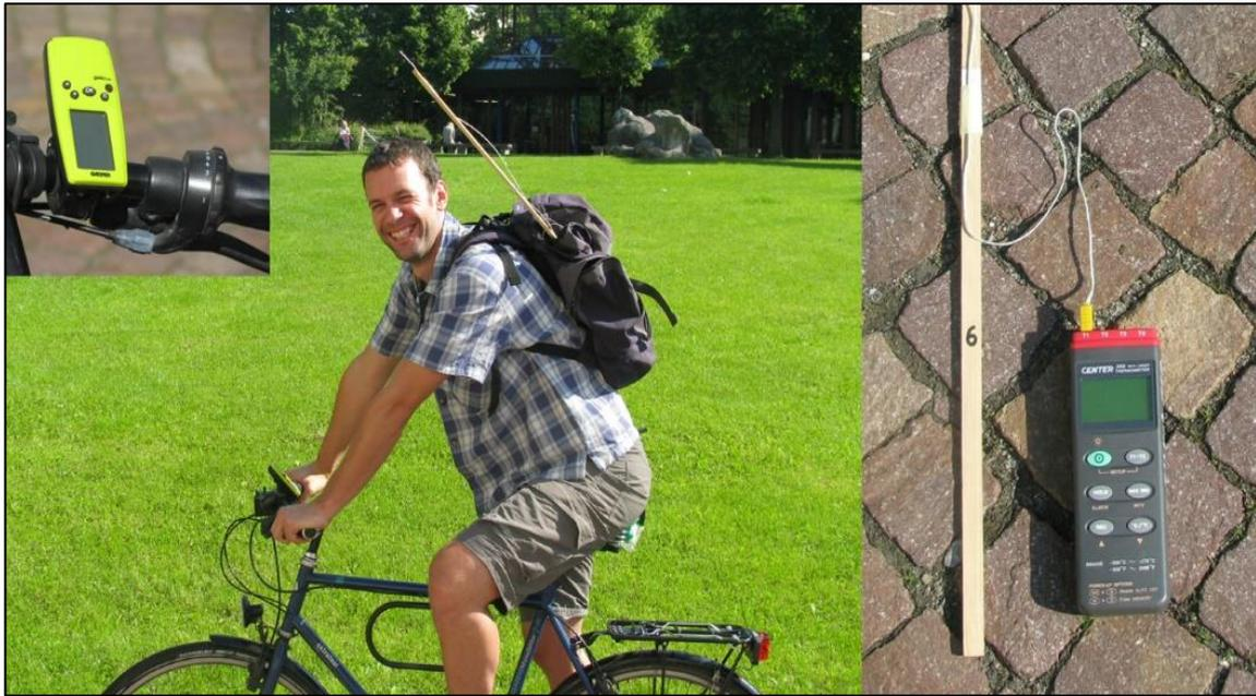
Abb. 4. Messausstattung: Fahrrad, GPS-Gerät und Temperaturlogger.
